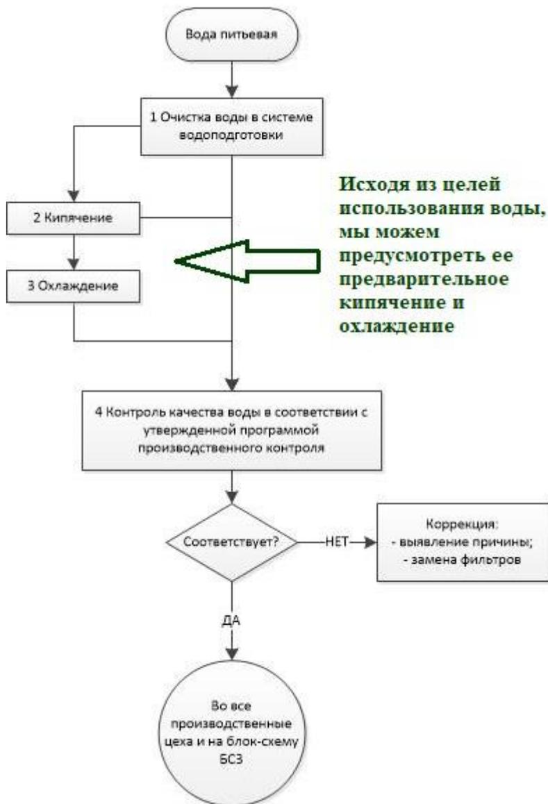
Рис. 4 Подготовка воды к производству
